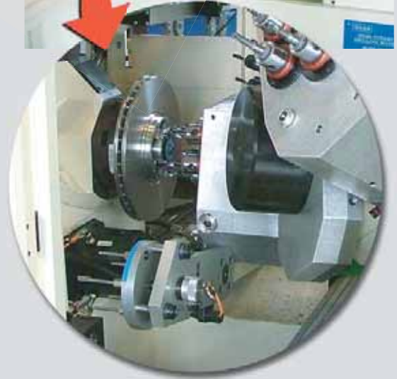
Augmentation du couple par réducteur de vitesse Erhöhung des Drehmoments durch Untersetzungs spindel High torque with speed reduction unit
